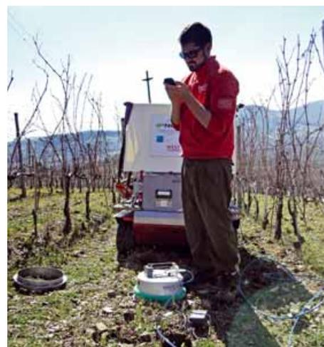
Foto 1 Immagine relativa allo strumento utilizzato per il rilievo delle emissioni dal suolo
