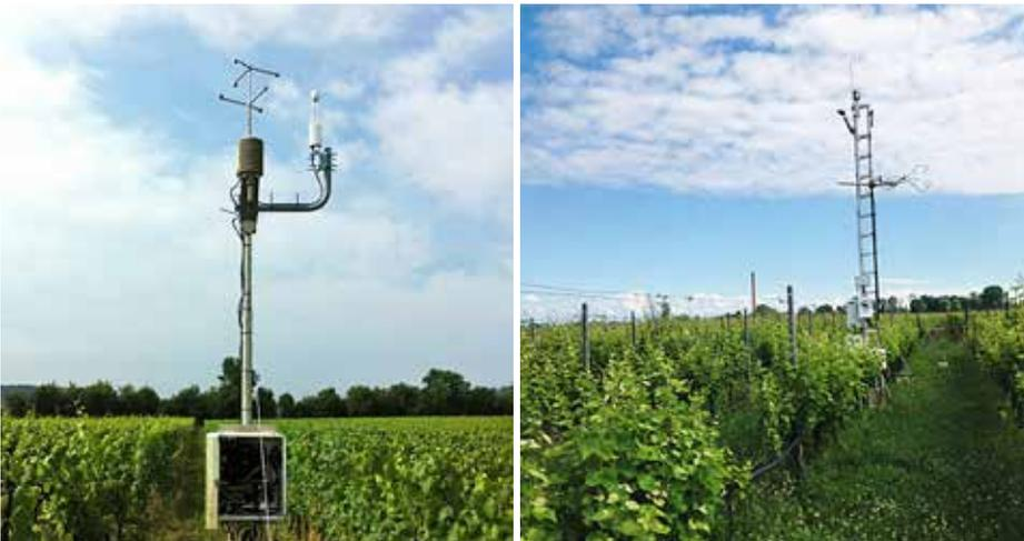
Stazioni di monitoraggio del flusso di CO<sub>2</sub> con la tecnica dell'*eddy covariance* nel vigneto appartenente alle aziende Guido Berlucchi & C. (a **sinistra**) 4e Bosco del Merlo (a **destra**)
