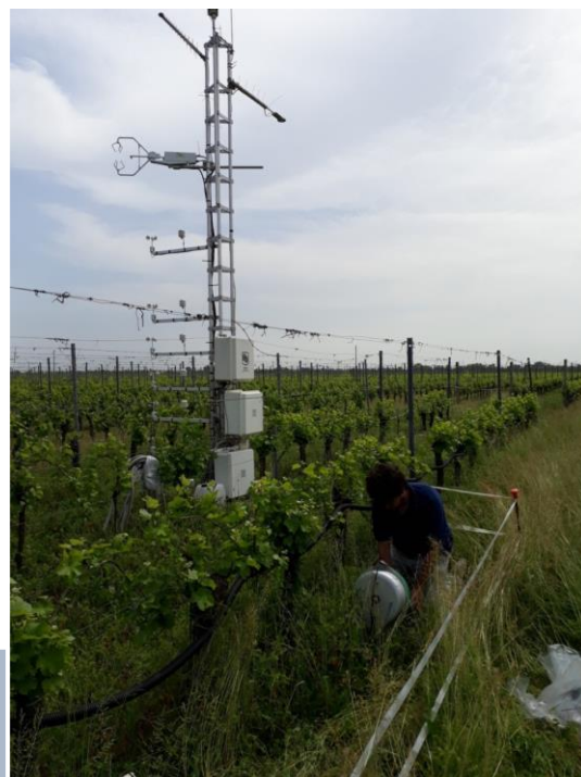
Stazione Eddy Covariance, installata presso il sito test VITISOM LIFE a Annone Veneto. Il monitoraggio dei dati è eseguito dai ricercatori delle Università di Padova.
